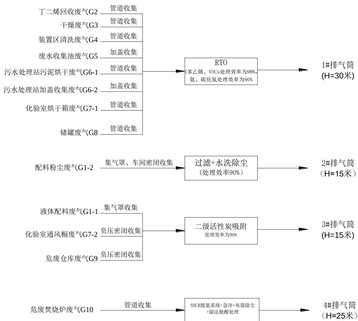
图 6.1.1-1 本项目有组织废气收集、处理流向图
